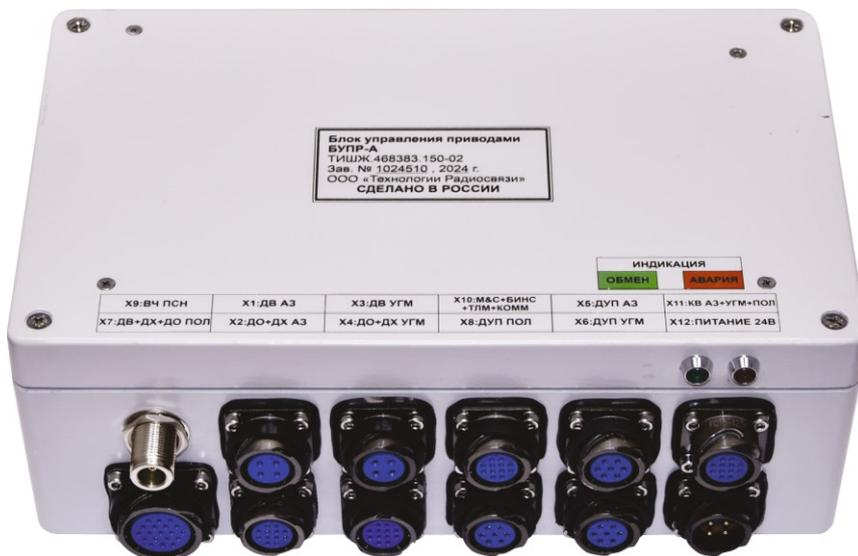
Рисунок 16 – Внешний вид блока БУПР-А ТИШЖ.468383.150-02
