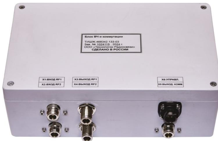
Рисунок 17 – Внешний вид блока ВЧ и коммутации ТИШЖ.468342.133-03
