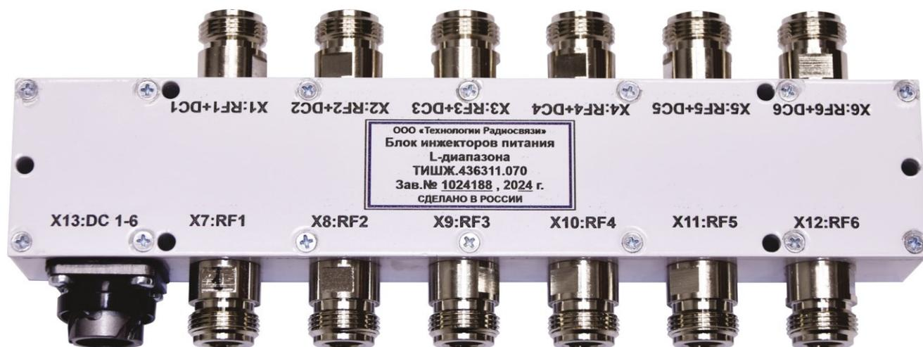
Рисунок 21 – Внешний вид блока инжекторов питания L-диапазона
